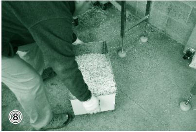
▲いっぱいになったら、粉碎されたキャップを取り出します。
