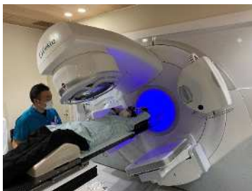
リニアック X線や電子線を体の外から照射してがんを治療する装置
